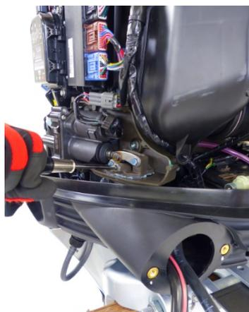
3. Inserire il cacciavite a stella con l'impugnatura del kit degli attrezzi nel foro del perno del cambio.
