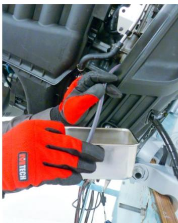
4. Posizionare una vaschetta di raccolta sotto il condotto di scarico. Raccogliere la benzina nella vaschetta di raccolta.
