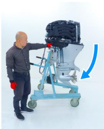
5. Inclinare il motore fuoribordo verso il basso, in posizione verticale, e lasciare scaricare completamente il carburante dal separatore del vapore.
