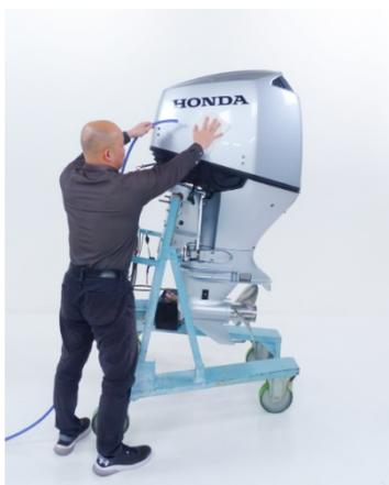
1. Risciacquare il motore fuoribordo con acqua pulita per rimuovere salsedine, sabbia, fango e così via. Rimuovere il coprimotore e risciacquare anche l'interno del coprimotore.
