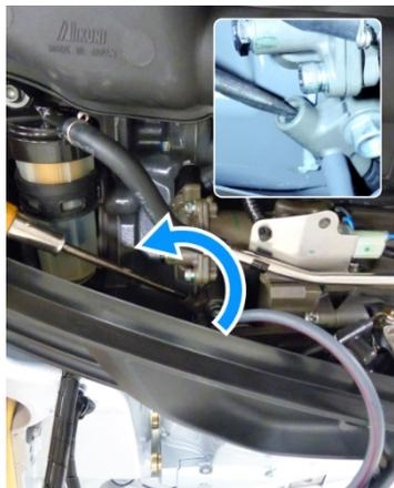
3. Svitare il bullone di scarico del separatore del vapore. Mentre il carburante fuoriesce, inclinare il motore fuoribordo verso l'alto.
