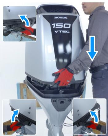
12. Installare il coprimotore e bloccare saldamente il fermo.
